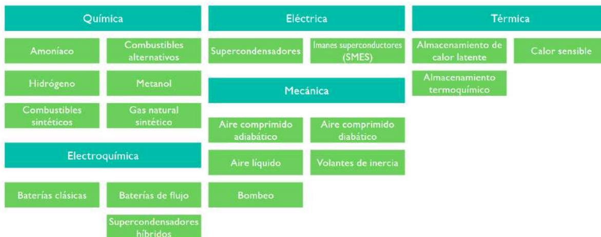
Figura 1: Clasificación de las tecnologías de almacenamiento energético. Obtenido de MITECO, 2021
